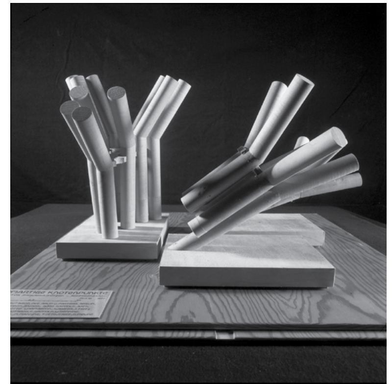
8 Frei Otto Baumartige Knotenpunkte. Modell der Stahlrohrstützen, 1977
